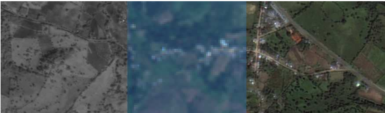
La préparation d'une image satellite consiste non seulement en une correction géométrique mais aussi en une adaptation des couleurs. A gauche : image noir et blanc ; au centre : image couleur peu détaillée ; à droite : assemblage des deux premières images pour la rendre plus agréable à l'œil.
