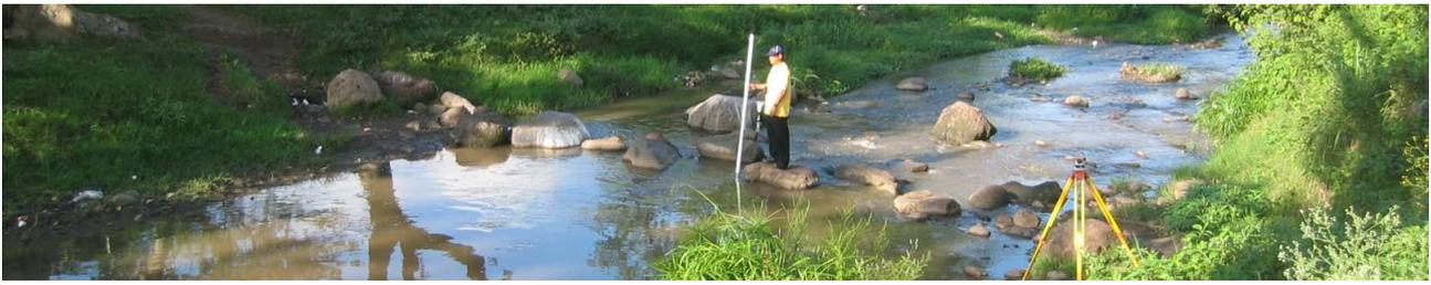
*Mesure de section transversale de rivière uniquement avec un niveau, une chevillière et un récepteur Garmin.*
